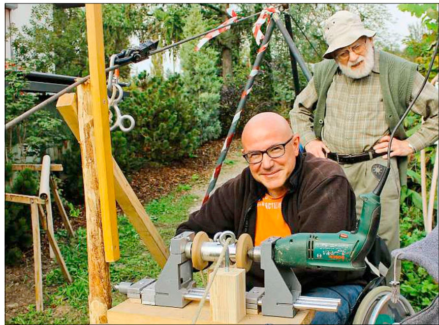
«Ufezieh» – Rémy Grenacher am Seilzug. Dank der Bohrmaschine hat er nun keine Blasen mehr an den Händen
